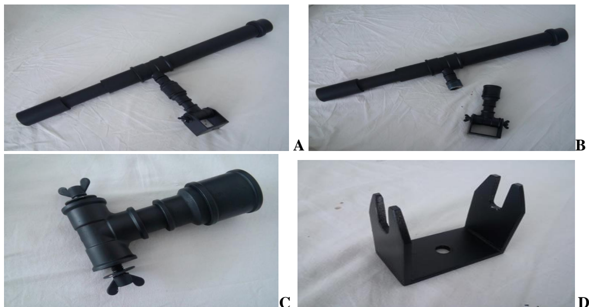
Figura 6.15 – Montagem auto azimutal da Luneta Astronômica (A).Mancal de ajuste para foco horizontal (B). Mancal de ajuste vertical com parafusos borboleta(C).Base de metal em U(D).
